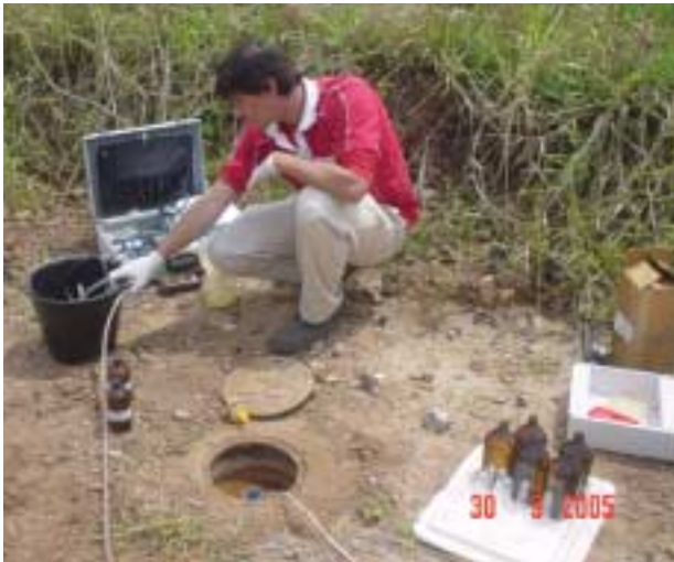
Prueba de un punto de medición de aguas subterráneas
